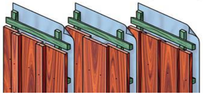
Verticale gevelbekleding, opdekwerk en channelsiding.
