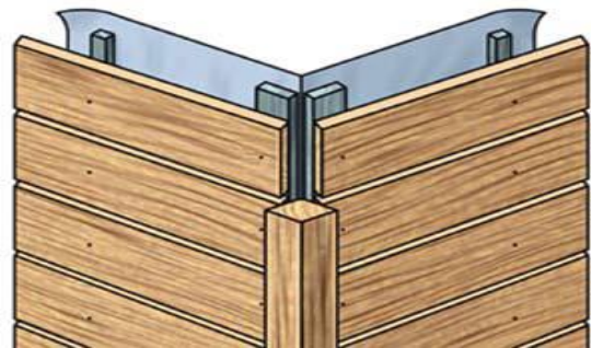
Voorbeeld open gevelbekleding. Afgeschuinde delen met mogelijke hoekoplossing
